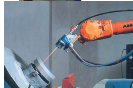
Pistolet de projection HVOF fil ( O_2 : 6 bars-7m 3 /h, C_3H_8 : 4bars-1m 3 /h)
